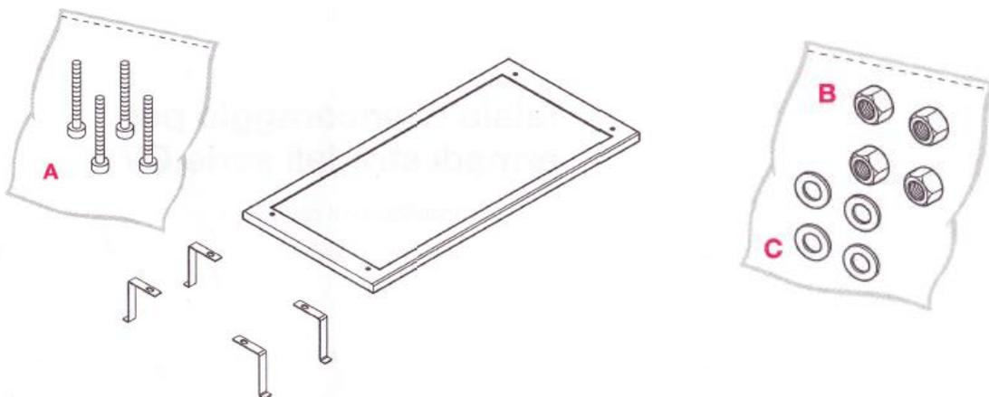
**WICHTIG!** Bitte beachten Sie, dass die Bodenplatte des Gehäuses **zwischen** dem Gehäuse und dem Rahmen zur Bodenmontage fixiert ist. Achten Sie beim Zusammenbau darauf, dass die Bodenplatte des Gehäuses zusammen mit dem Bodenmontage Rahmen und dem Gehäuse befestigt und fixiert ist / wird.
